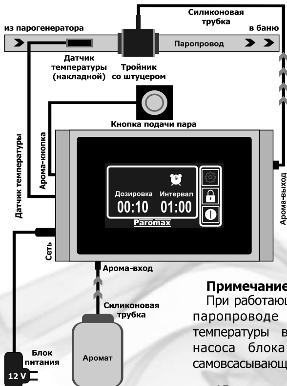
Рис. 2. Схема подключения диспенсера ароматов
